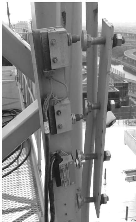
图4.1-6 弓板式力矩限制器 变形严重
