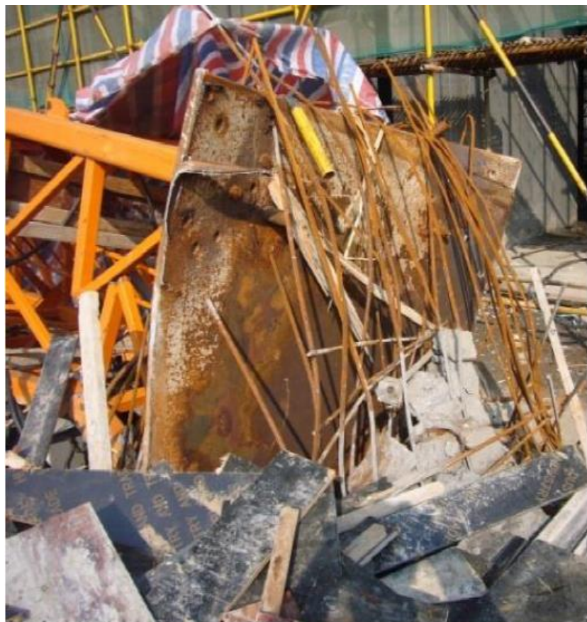
钢平台与格构柱的焊接未设加筋板，且全部焊缝几乎都为虚焊的事故案例
