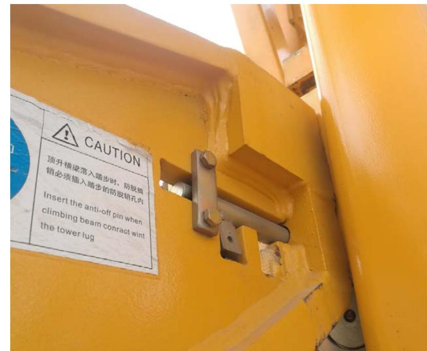
一般的顶升横梁防脱装置（安全装置）
