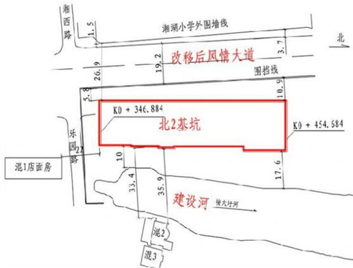
基坑土方开挖共分为6个施工段，总体由北向南组织施工。至事故发生前，第1施工段完成底板混凝土施工，第2施工段完成底板垫层混凝土施工，第3施工段完成土方开挖及全部钢支撑施工，第4施工段完成土方开挖及3道钢支撑施工、开始安装第4道钢支撑，第5、6施工段已完成3道钢支撑施工、正开挖至基底的第5层土方同时，第1施工段木工、钢筋工正在作业；第3施工段杂工进行基坑基底清理，技术人员安装接地铜条；第4施工段正在安装支撑、施加预应力，第5、6施工段坑内2台挖机正在进行第5层土方开挖。事故前基坑已见底而未作结构的区段至少3段（即60~70米长）以上。
