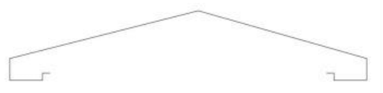
图 4 防雨帽两侧起脊堵头示意图
