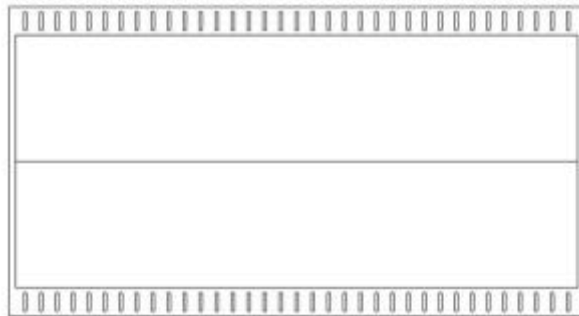
图6 防雨帽散热孔示意图
