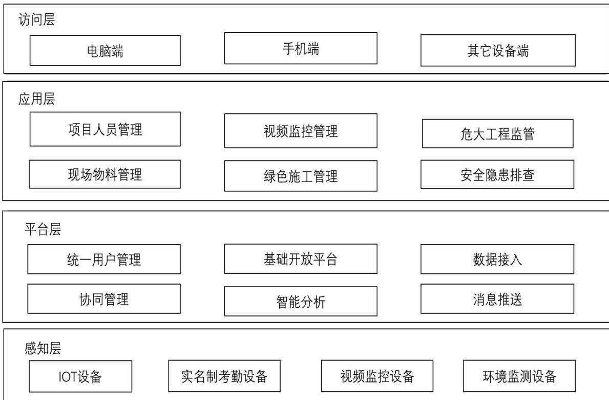
图 5.1 智慧工地平台架构图
